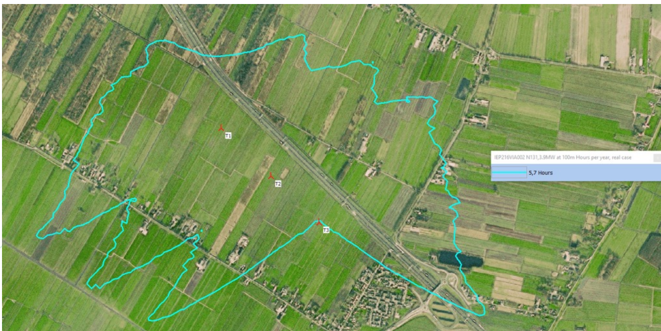
Slagschaduwberekening 3 windturbines N131
