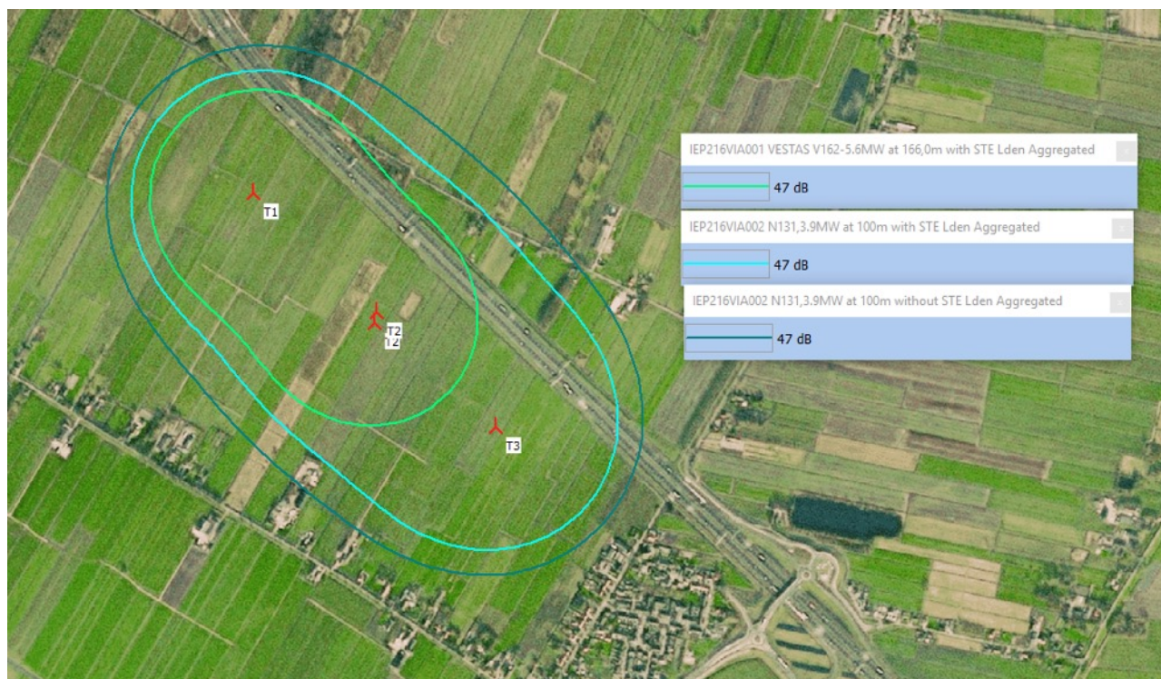
Geluidscontouren 47dB twee scenario's gezamenlijk: 2 windturbines V162 en 3 windturbines N131 (met en zonder STE – geluidreducerende maatregelen)
